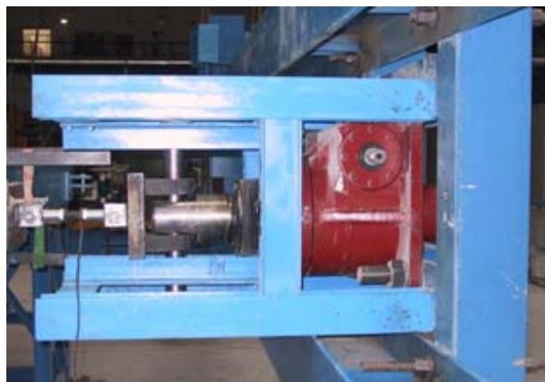
Figura 10. Martinetto elettromeccanico utilizzato per le prove di laboratorio.
