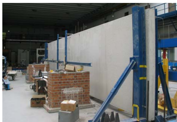
Figura 9. Posizionamento del pannello con asse orizzontale.
