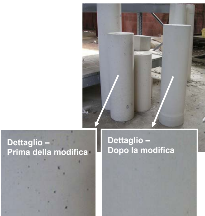
Fig. 3 - Confronto tra i cilindri prodotti in laboratorio centrale Unical con l'additivo 2 prima e dopo la modifica – dettagli del faccia a vista.
